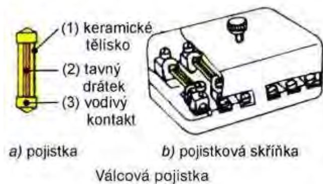
Obr. č. 85 – Válcová pojistka [6]
